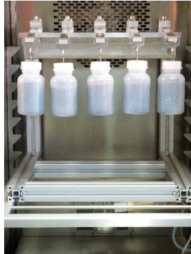
Bild 1 Probekörper, montiert und belastet in Vorrichtung
