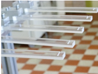
Bild 2 Probekörper, montiert in Vorrichtung, unbelastet nach Lagerung
